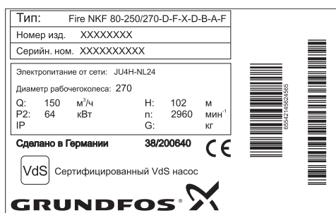
Рис. 10 Пример фирменной таблички насосной установки Fire NKF
